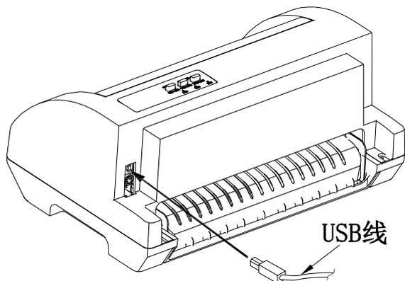
**注** 在连接USB电缆后，需防止对插头的碰撞。
