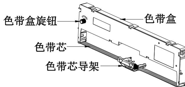
6. 将色带盒两边的卡扣对准打印机两侧的安装槽，稍用力向前推进，直到完全卡到位。
