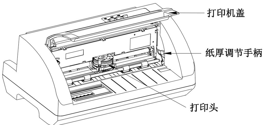
△注意 在打印机处于开机状态时，请不要移动打印头，否则会损坏打印机。此外，如果刚使用完打印机，打印头可能很热，此时请勿触碰打印头。
